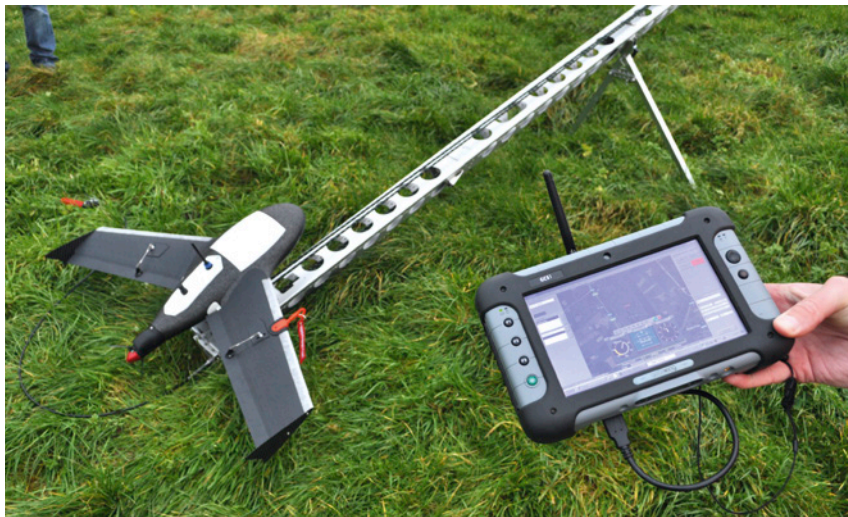
▲ Landmeetkundig ingenieursbureau Geo Infra gebruikt een drone om een volledig en nauwkeurig 3D beeld op te bouwen van een grote oppervlakte.
